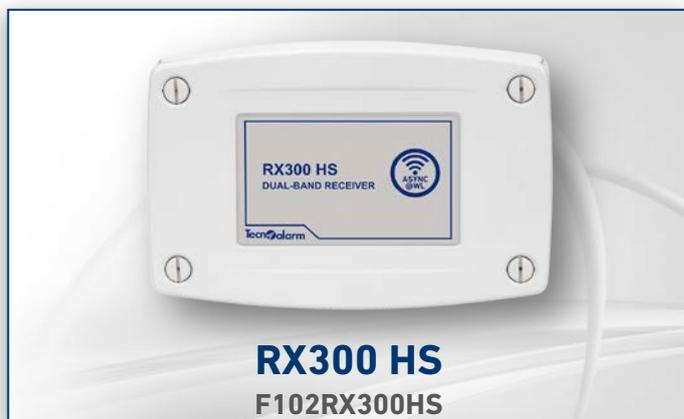
Tecnoalarm termina la produzione del RX300 che verrà sostituito dal ricevitore radio RX300 HS. Il dispositivo può essere utilizzato in abbinamento ai sistemi Tecnoalarm che gestiscono dispositivi radio su Bus di comunicazione RS485 lento (9.600 Baud) o veloce (38.400 Baud). Il ricevitore è in grado di operare su due frequenze di ricezione: 433,42MHz e 868,95MHz. Per ricevere e discriminare le due frequenze, il ricevitore dispone di due antenne accordate sulle rispettive frequenze di ricezione.
